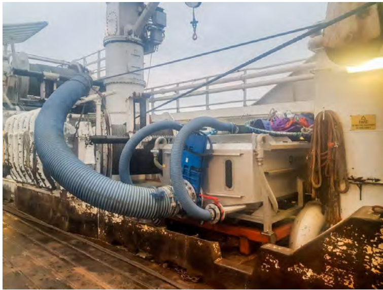
Test av tank til levendelagring av trålfangst, fra forsøk om bord i tråleren "J. Bergvoll". Foto: Stein Harris Olsen, Nofima
